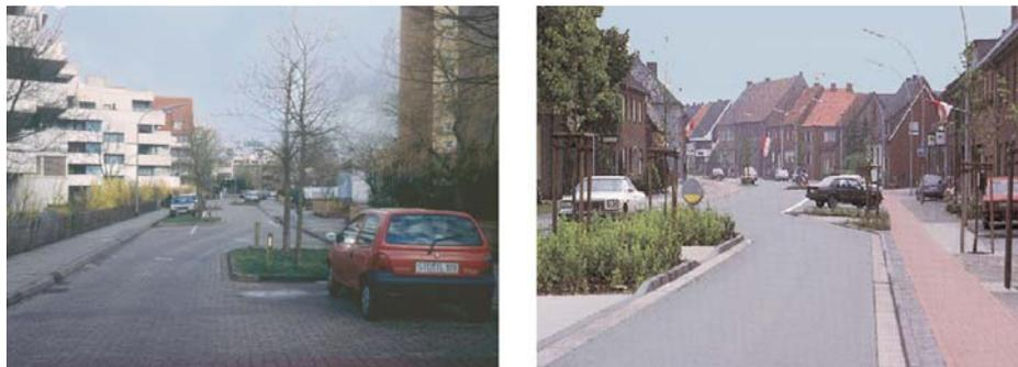
**Figura 2** - Due esempi di chicane realizzate mediante lo sfalsamento dei parcheggi, con elementi fissi (aiuole e alberi) in corrispondenza degli attestamenti (fonte: sito Internet <http://www.walkinginfo.org>)
