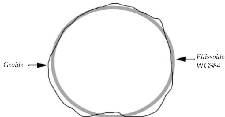
Figura 6.1 Modello ellissoidico con geoide; il geoide non coincide con l'ellissoide essendo una forma fisica invece che geometrica
