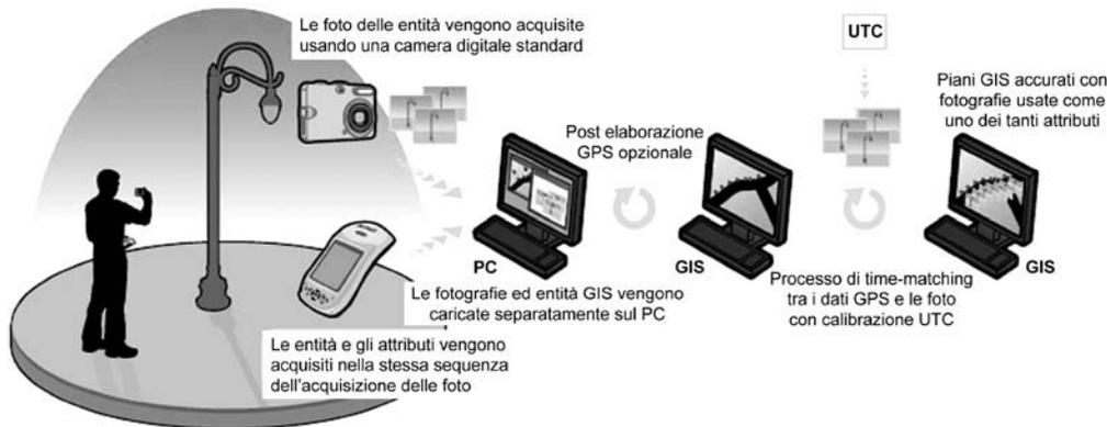
Le foto digitali ed i punti GPS vengono trasferiti separatamente sul PC. In questa fase, nessuno dei due dati sorgente è direttamente collegato all'altro. Se il dato GPS non è stato corretto in tempo reale, è possibile effettuare la correzione differenziale dei dati GPS attraverso la post elaborazione, fase eseguibile solo se i dati GPS sono stati acquisiti da un ricevitore GPS professionale.
