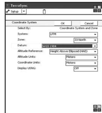
Figura 2: Dal menù *Coordinate System* si accede ai diversi DATUM e sistemi di proiezione in cui vogliamo archiviare le coordinate dei punti rilevati.
