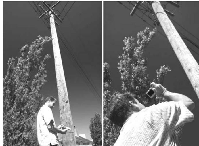
*Figura 5: Per prendere una posizione GPS, è necessario posizionare il ricevitore il più vicino possibile all'entità, ma per entità ingombranti, come un palo elettrico, questa non è la migliore posizione per acquisire una foto.*
