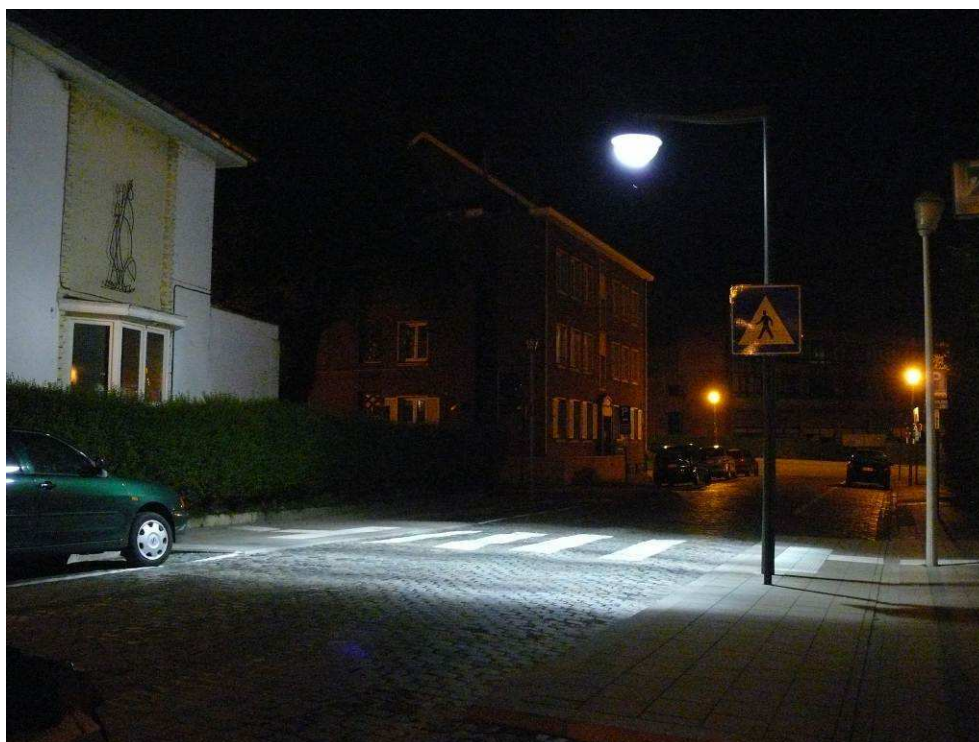
Figura 4-18 Illuminazione artificiale attraversamenti pedonali (Bruxelles 2010)
