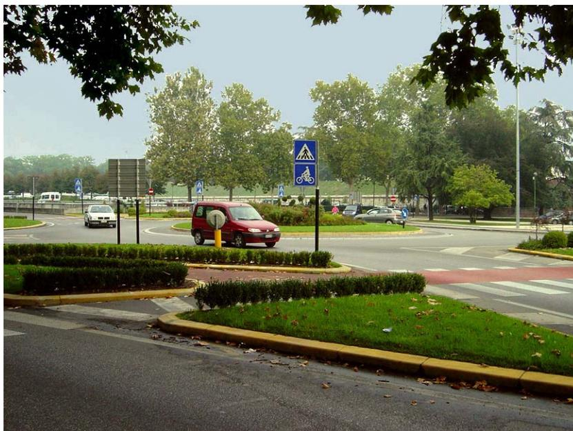
**Figura 17** - Secondo le *Norme sulle caratteristiche funzionali e geometriche delle intersezioni stradali*, nelle rotatorie poste in ambito urbano gli attraversamenti pedonali devono essere arretrati rispetto all'anello e ben segnalati
