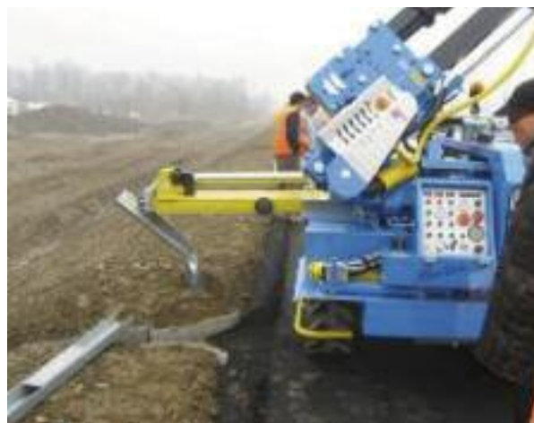
Fig. 10 • Attrezzatura MA.RTE per la misura dell'effettiva resistenza delle barriere.
