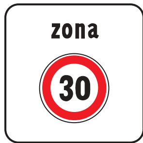
Figura II.323/a Art. 135 ZONA A VELOCITÀ LIMITATA Indica l'inizio di un'area in cui non è consentito superare la velocità riportata nel segnale.
