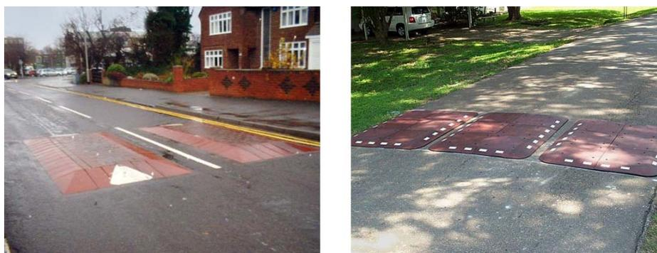
**Figura 5** - Nell'immagine di sinistra la distanza tra i due cuscini è corretta; nell'immagine di destra la distanza è troppo ridotta e i cuscini arrecano disagio anche ai mezzi pesanti (fonte: sito Internet <http://walkinginfo.org>)
