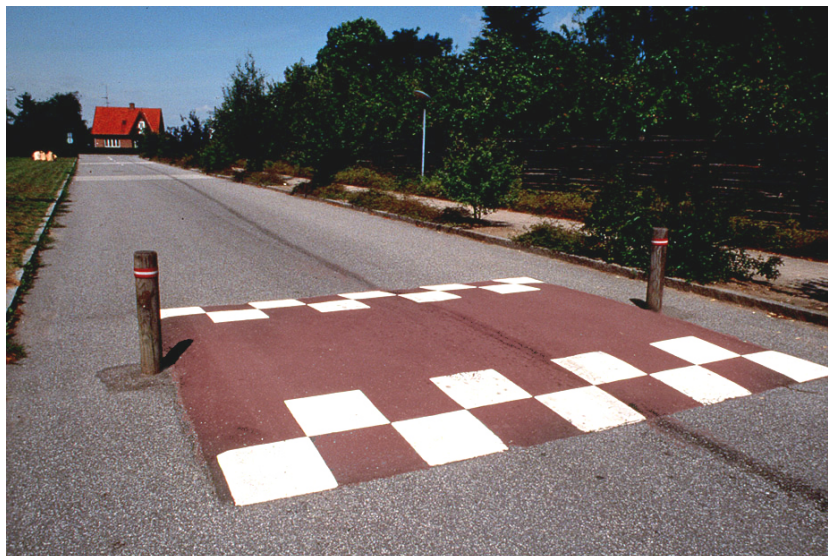
Figura 6 - Un dosso con un varco laterale per i ciclisti, accompagnato da un dissuasore per indirizzare le automobili, negli Stati Uniti (fonte: sito Internet http://www.walkinginfo.org )
