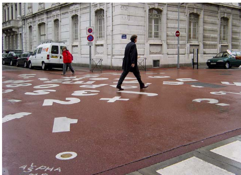
Figura 4 - Un'intersezione rialzata in Francia in cui i pedoni possono attraversare anche in diagonale
