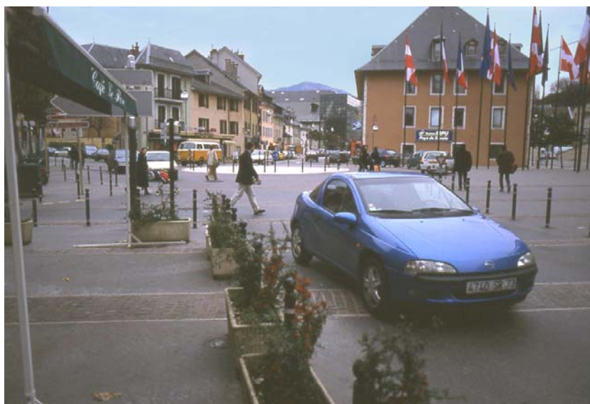
Figura 8 - Una rotatoria a Chambéry in cui i pedoni hanno facoltà di attraversare l'anello e l'isola centrale in ogni punto, con diritto di precedenza sui veicoli
