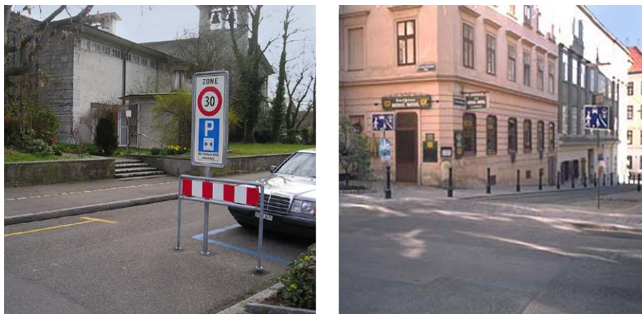
Figura 4 - Un ingresso di "zona 30" a senso unico alternato, realizzato mediante il posizionamento di segnali verticali, transenne e una fila di posteggi in linea (a sinistra), e una porta a senso unico, contenente un attraversamento pedonale rialzato
