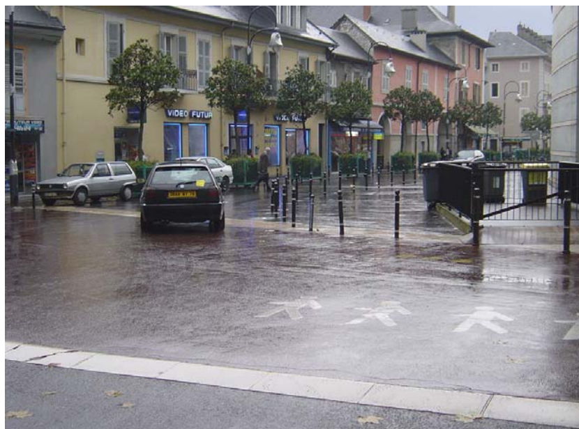
Figura 3 - Una strettoia riduce ad una sola corsia una strada a doppio senso di marcia, in corrispondenza di una piattaforma pedonale, costringendo i veicoli a rallentare e talvolta a procedere a senso alternato
