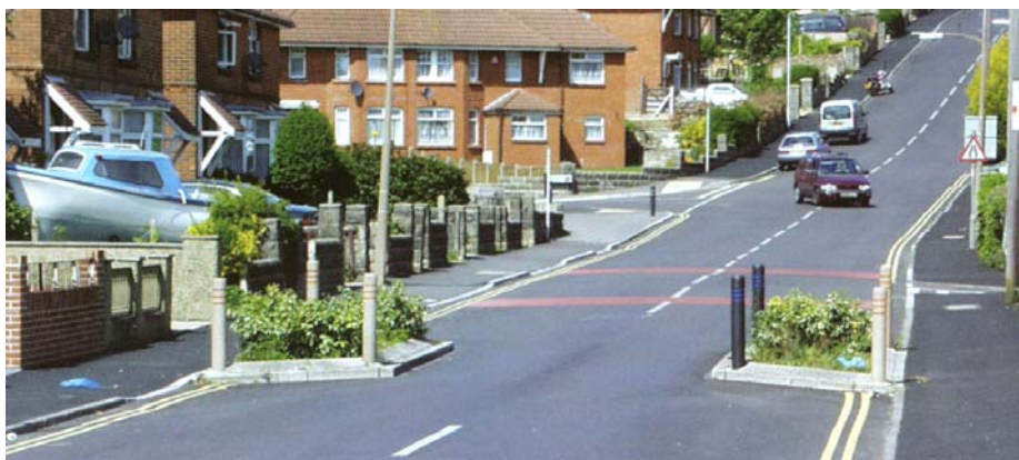
Figura 2 - Una strettoia realizzata mediante l'inserimento di aiuole verdi e dissuasori, per impedire l'attraversamento pedonale in quel punto (fonte: IHT, 2005, Traffic Calming Techniques )
